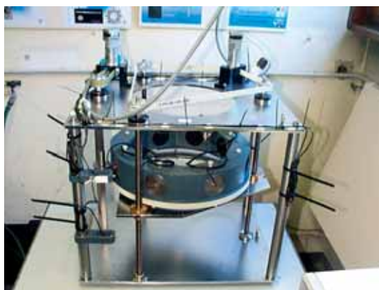
Fig. 13 : Prototype de tomographe en diffraction 8 voies 2,25 MHz (LMA). permet l'acquisition de 8 \times 8 = 64 diffractogrammes donnant accès à 16 projections
