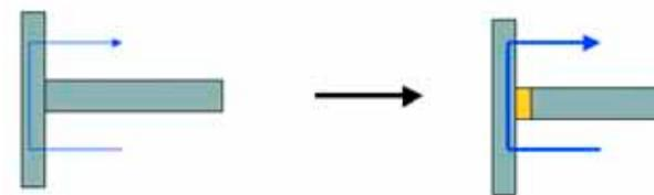
Fig. 2 : Augmentation de la transmission d'énergie vibratoire par la façade par ajout d'un rupteur thermique.
