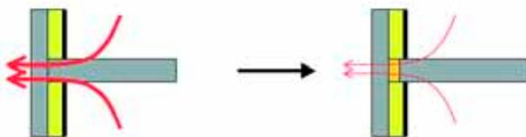
Fig. 1 : Diminution des déperditions d'énergie par ajout d'un rupteur thermique
