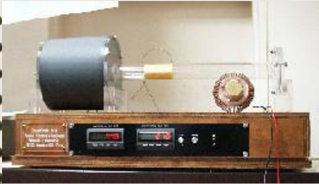
Réfrigérateur thermoacoustique (démonstrateur)
